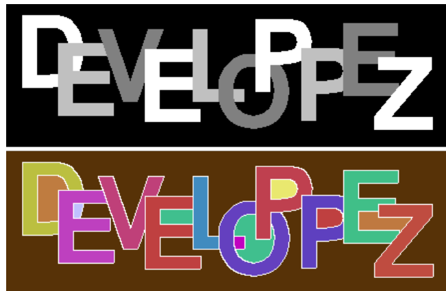
Figure 8.2. Résultat de l'algorithme utilisé pour étiqueter les régions des textures. Les régions sont caractérisées par leur niveau d'intensité, puis étiquetées (chaque étiquette est représentée à l'aide d'une couleur spécifique).
