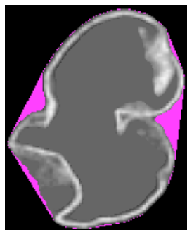
Figure 5.4. Illustration du calcul de la mesure N_{Cce} . On compte le nombre de composantes connexes d'écarts (le nombre de composantes en violet).
